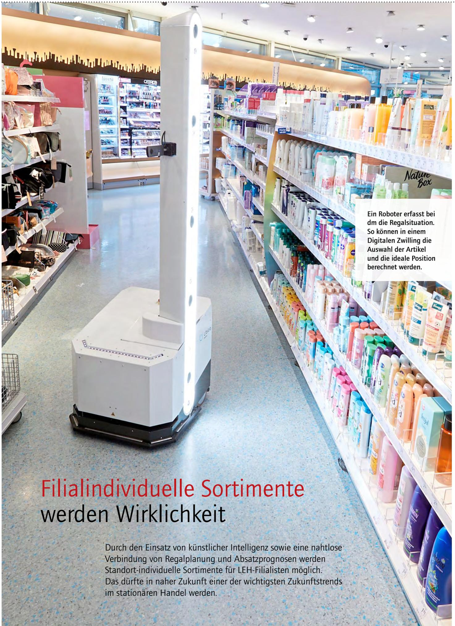
Ein Roboter erfasst bei dm die Regalsituation. So können in einem Digitalen Zwilling die Auswahl der Artikel und die ideale Position berechnet werden.
