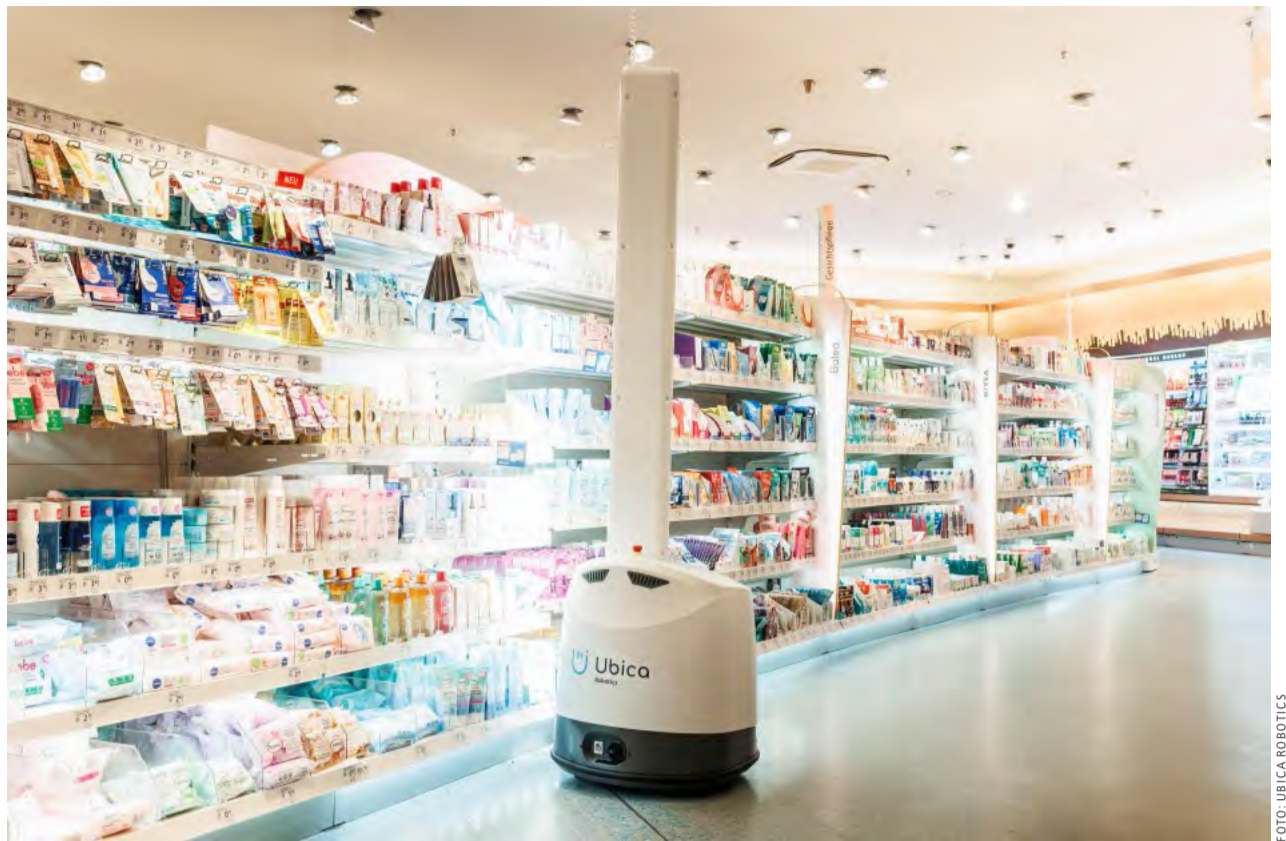
Neue Technik: dm nutzt Roboter, um Daten für Digitale Zwillinge der Läden zu erfassen. Das ist die Basis für filialindividuelle Sortimente.
