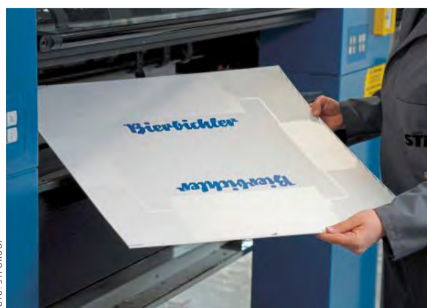
Treffsicher: Wellpappe-Schachteln etwa für stark fettende Lebensmittel können vor dem Falten nur an den Stellen lackiert werden, die später Direktkontakt zum Füllgut haben.
