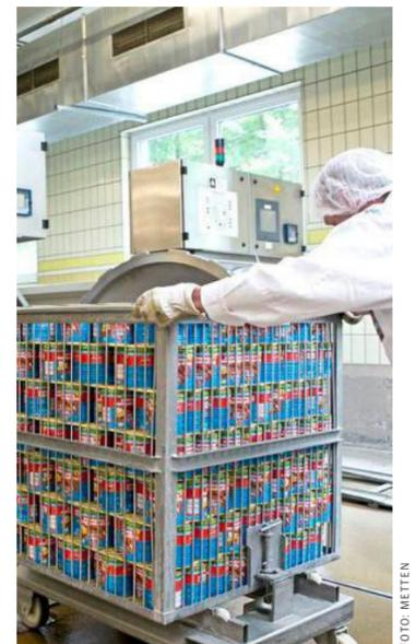
**Haltbar:** Konserven werden im Autoklaven sterilisiert.
