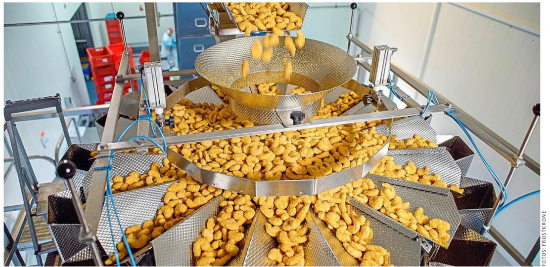
Mahlzeit für Zwischendurch: Im Produktionsprozess werden die Knusper-Garnelen paniert, gebacken und anschließend gefroren.
